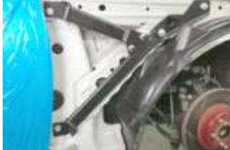
全ての取付個所の本締めが完了しましたらタイヤハウスカバー、タイヤを取付ます。反対側も同じ手順で行います。これでガッチリサポート組み付け作業は完了です。
